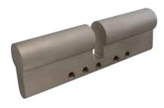
Standard Doppelblindzylinder 100 mm Gesamtlänge, gebohrt für 25+75, 35+65, 50+50, 40+60, 30+70 (Außenlänge + Innenlänge) **Application:** for all mortise door locks in Europrofile requiring no key operation in the door.
